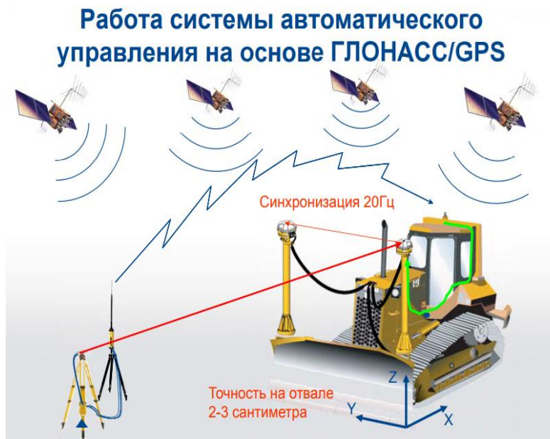
Рисунок 36 - Принципиальная графическая схема управления рабочим отвалом землеройной техники
