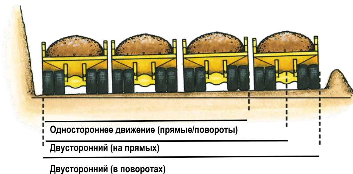
Рисунок 10 Эмпирическое правило ширины технологической дороги в зависимости от ширины автосамосвала
