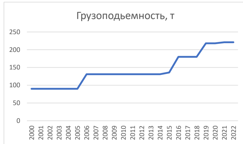
Рисунок 8 - График изменения номинальной грузоподъемности автосамосвалов на ОГР в Казахстане за последние 22 года
