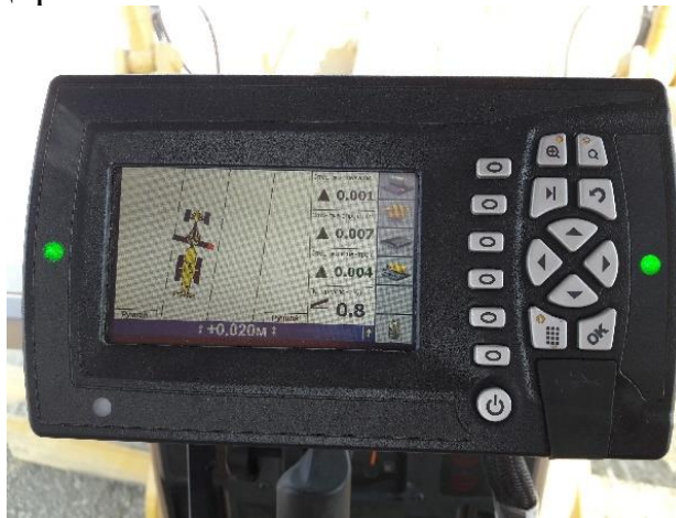
Рисунок 37 - Графический монитор в кабине оператора автогрейдера
