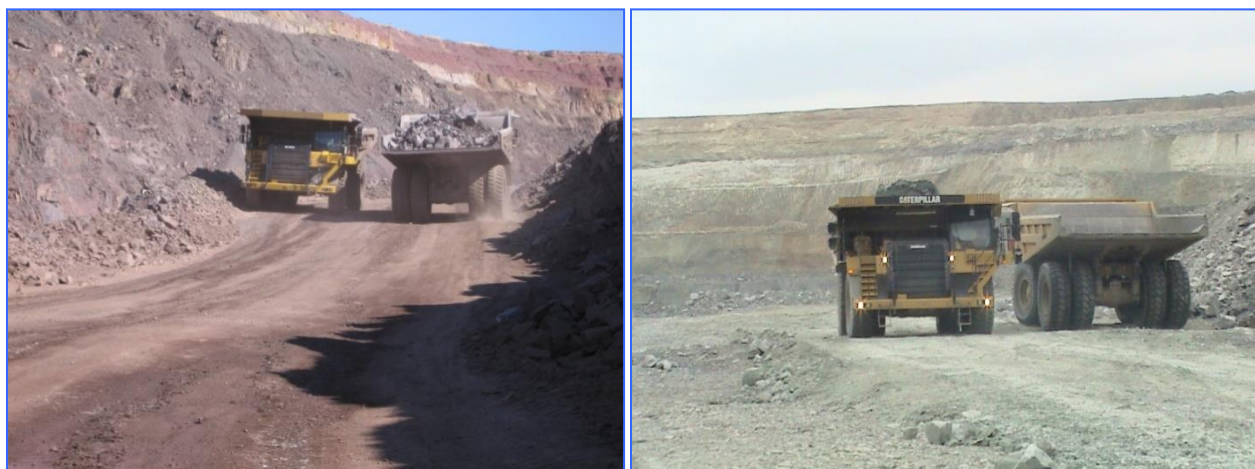
Рисунок 11 - Примеры технологической дороги не достаточной ширины
